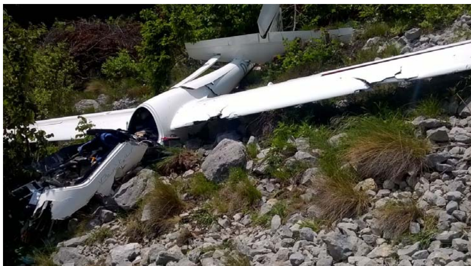
Foto 5: danneggiamento dell'abitacolo e del bordo di attacco semiala sinistra.
